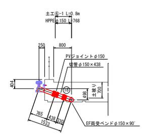
備考: ●は現場耐震性鋼管継手接続箇所(7箇所)とする。
