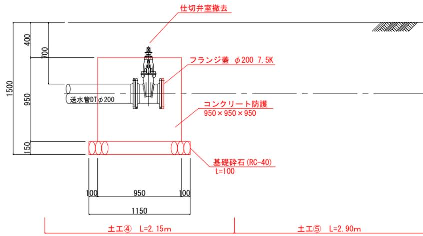
流出管撤去断面図
