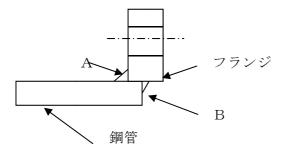
3 突合せ溶接を行う場合は、開先加工を適正に行うとともにルート間隔を保持することによ
