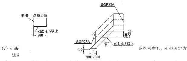
(8) 勾配のある歩廊と階段の乗り継ぎ部には、歩廊に水平部を設ける。この踏めんは、階段の踏面以上の長さとする。
