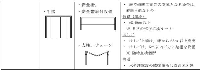
(注)手摺のコンクリート面取付は原則として、あと施工アンカー(接着系)による。
