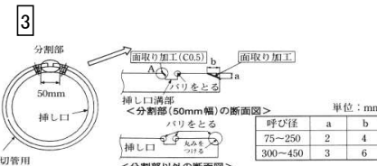
図58 挿し口のバリ取りおよび端面処理
