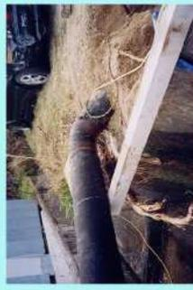
沼田東町釜山 鋼管φ200 継手（溶接箇所）破損
